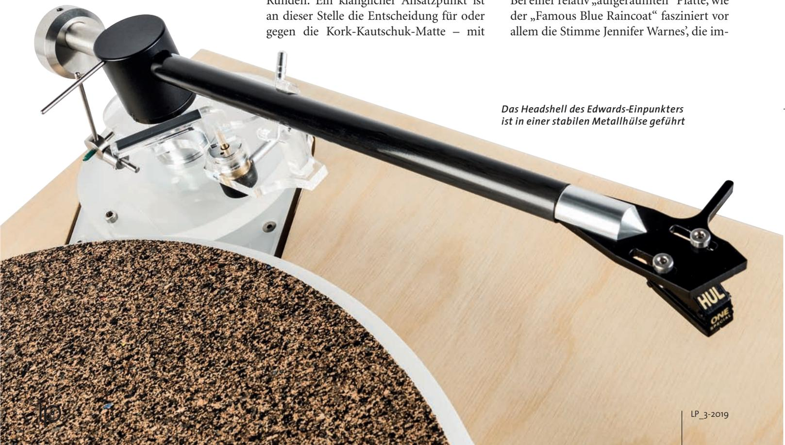
*Das Headshell des Edwards-Einpunkters ist in einer stabilen Metallhülse geführt*
